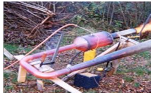
Рис.2. Нагрів корпусу безклапанного ПуВРД під час роботи.
